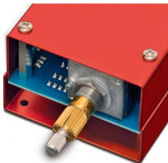
**HÄUSLE-POTI:** Das Lautstärke-Potenzimeter sitzt in einem eigenen Blechgehäuse, gut geschützt vor Staub und Störstrahlung.
